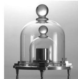
Ci-contre le kg étalon sous différentes cloches pour qu'il ne perde pas de matière et qu'il reste propre.
