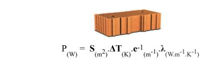
Pour un mur, un plafond ou un sol d'épaisseur e avec un isolant donné
